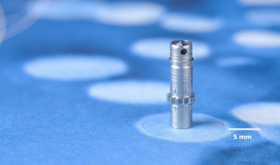
*Auch rotationssymmetrische Kleinbauteile ohne Stirnfläche wie diese Kopfwelle eines Dentalinstruments lassen sich mit dem Track & Trace Fingerprint-Verfahren anhand der Mantelfläche rückverfolgen.*
