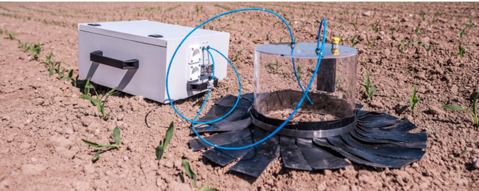
*mobiler Lachgassensor: Die Probennahme erfolgt bodennah über eine Sammelglocke, das eigentliche Messsystem verbirgt sich im Koffer.*
